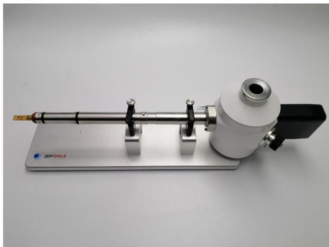
图 3-1 单倾冷冻样品杆（日本电子电镜兼容）
